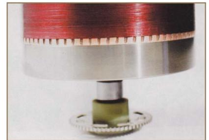
*Copper Motor Rotor in Tesla Motor's Powertrain*
